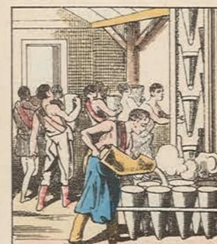
Le **MOULAGE**, ou mise en forme, s'opère en versant la **masse cuite** dans des vases de tôle vernie ayant la forme d'un pain de sucre renversé; la masse cuite versée bouillante se refroidit pendant 24 heures environ.
