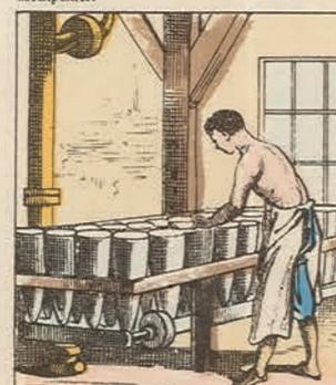
Afin de précipiter l'écoulement du sirop de clairage par le petit trou ménagé au bas de toutes les formes à pain de sucre, on les place sur un appareil nommé **SUCETTE**, qui, à l'aide du vide opéré dans l'appareil, suce et aspire rapidement le sirop resté liquide; le sucre cristallisé peut sécher alors rapidement.
