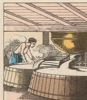
Le sirop à la sortie des filtres est envoyé aux **APPAREILS À CUIRE** où l'eau s'évapore et les cristaux de sucre se forment. La masse qui en sort tombe dans de grandes cuves appelées **RÉCHAUFFOIRS**, d'où des tuyaux la distribuent aux ateliers de moulage.
